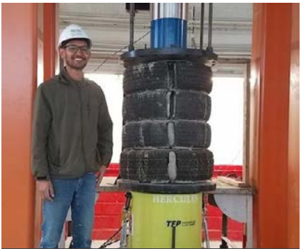
Alle kolommen werden in een pers geplaatst die meer dan 2,5 miljoen pond kracht kon uitoefenen
